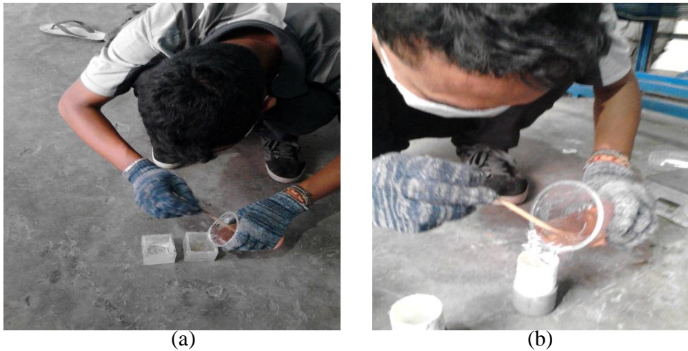
Gambar. 3.21. Penuangan campuran epoxy resin dan katalis dengan serat plastik kedalam cetakan kubus (a), dan silinder (b).
