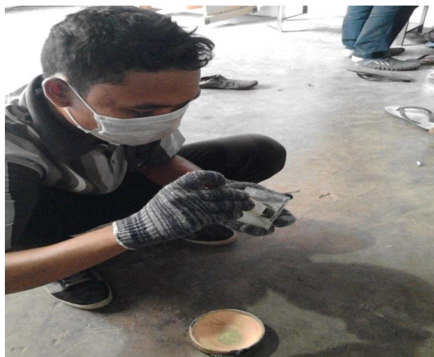
Gambar. 3.18. Mengoleskan mirror glaze pada bagian cetakan spesimen.
