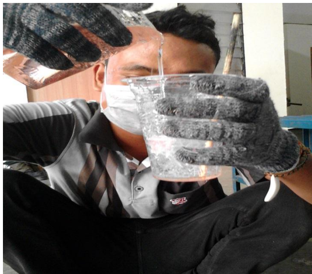
Gambar. 3.20. Mencampurkan epoxy resin dan katalis dengan serat plastik.
