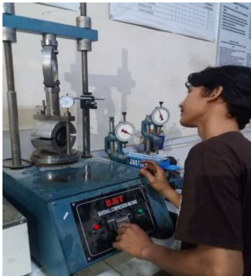
Gambar L16: Pengujian Marshall Test .
