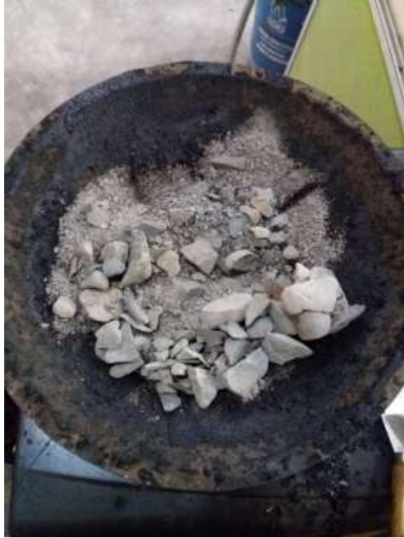
Gambar L5: Proses pencampuran agregat menggunakan filler abu batu.
