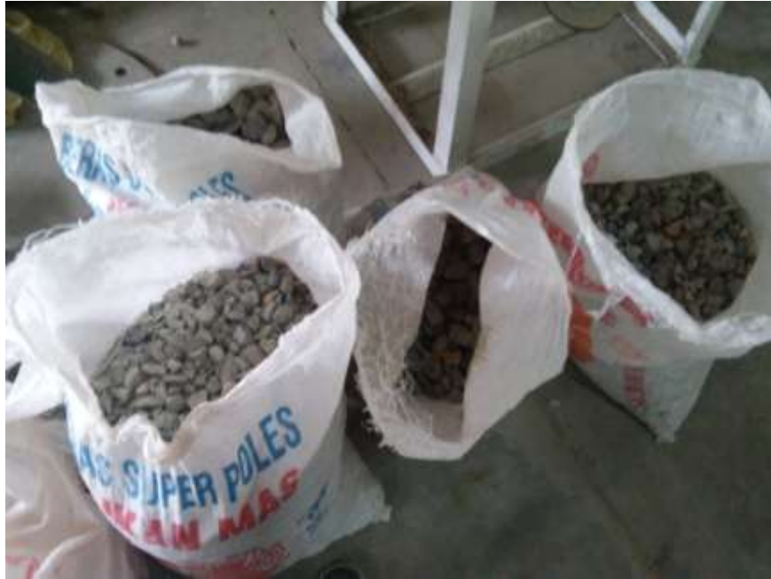
Gambar L1: Material agregat kasar yang akan digunakan.
