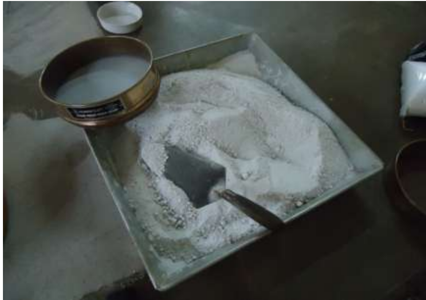
Gambar L3: Limbah karbit yang akan digunakan pada campuran aspal.
