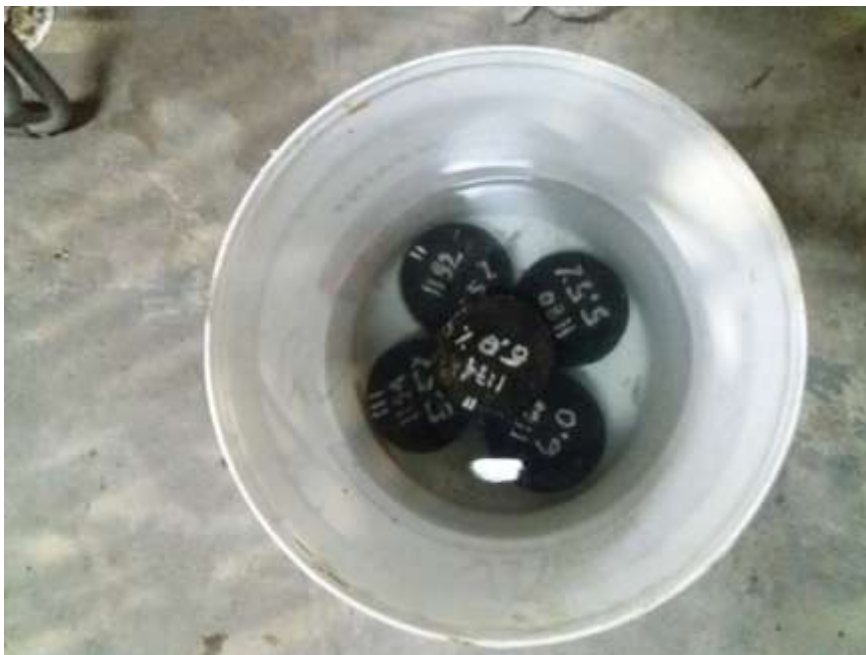
Gambar L14: Proses perendaman benda uji.
