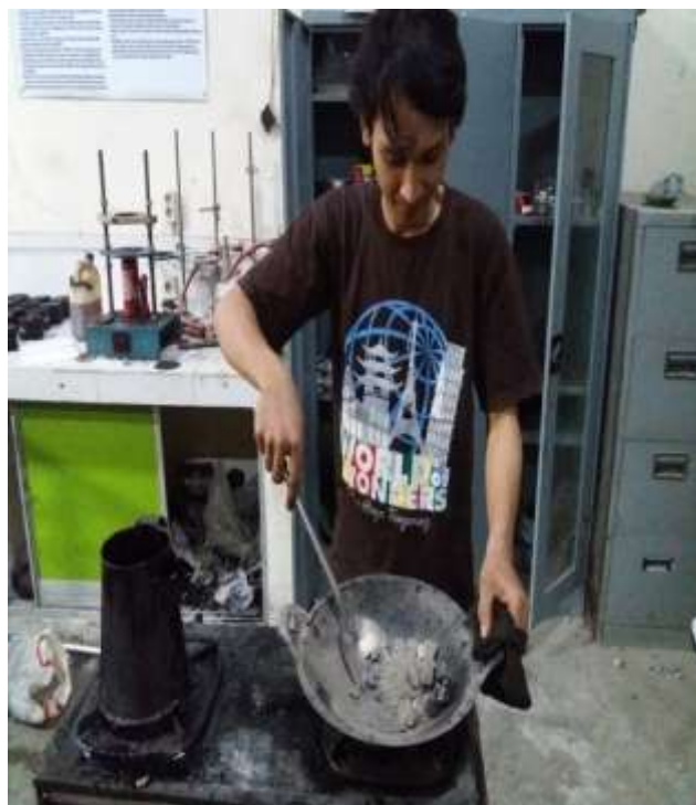
Gambar L8: Proses pemanasan agregat dan aspal.
