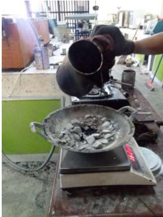
Gambar L7: Proses pencampuran aspal dan agregat.
