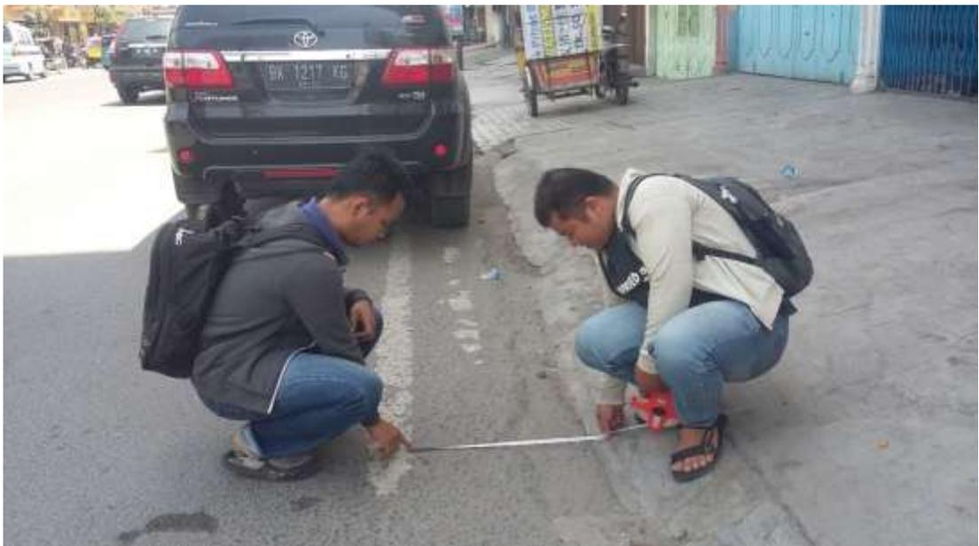
Gambar L.3: Pengukuran Bahu Jalan Di Jalan M.T. Haryono Depan Medan Mall
