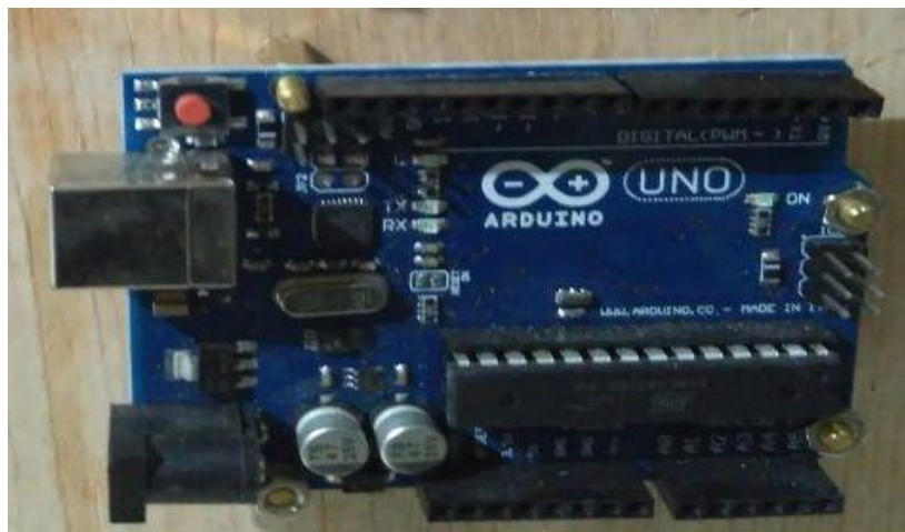
Gambar 4.1 Rangkaian Arduino Uno Mikrokontroler Atmega 328
