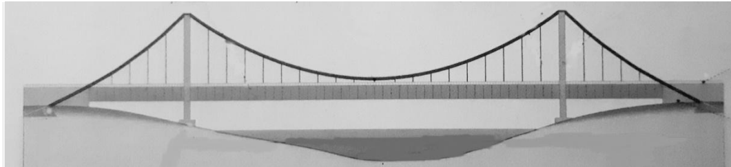
Gambar 2.6: Jembatan Gantung (Corbell & Archambault, 2007).
