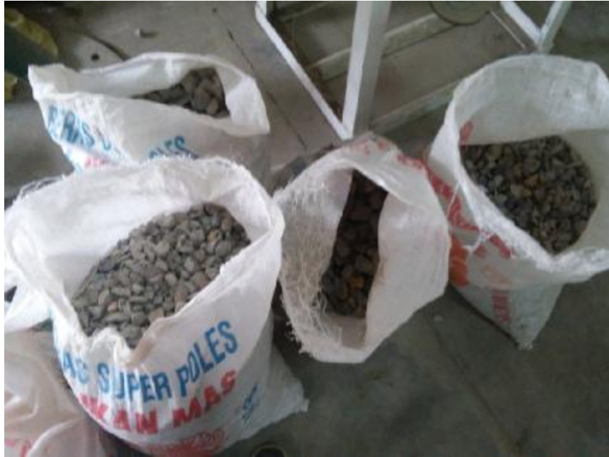
Gambar L1: Material agregat kasar yang akan digunakan.
