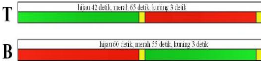
Gambar 4.2: Siklus traffic light simpang Jalan Jend. Gatot Subroto-Iskandar Muda.
