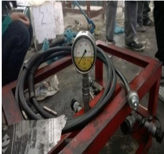
Gambar 3.14: Selang Hydraulic dan Manometer
