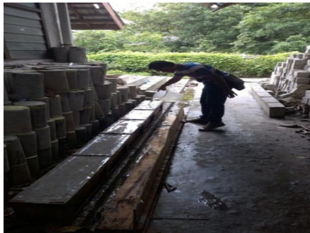
Gambar 3.11: Perawatan benda uji balok.
