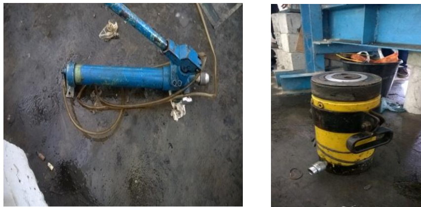
Gambar 3.13: Alat Pompa dan Hydraulic Jack .
