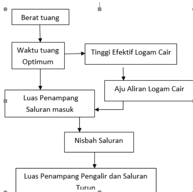
Gambar 2.3 Diagram alir perhitungan perancangan pengecoran
