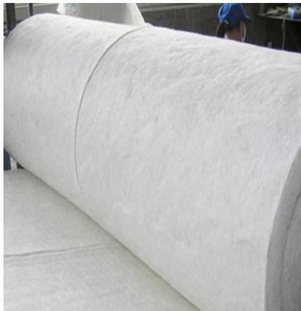
Gambar 2.8. Bahan isolasi termal bentuk serat
