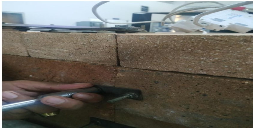
Gambar 4.10. plat strip dan baut fiser
