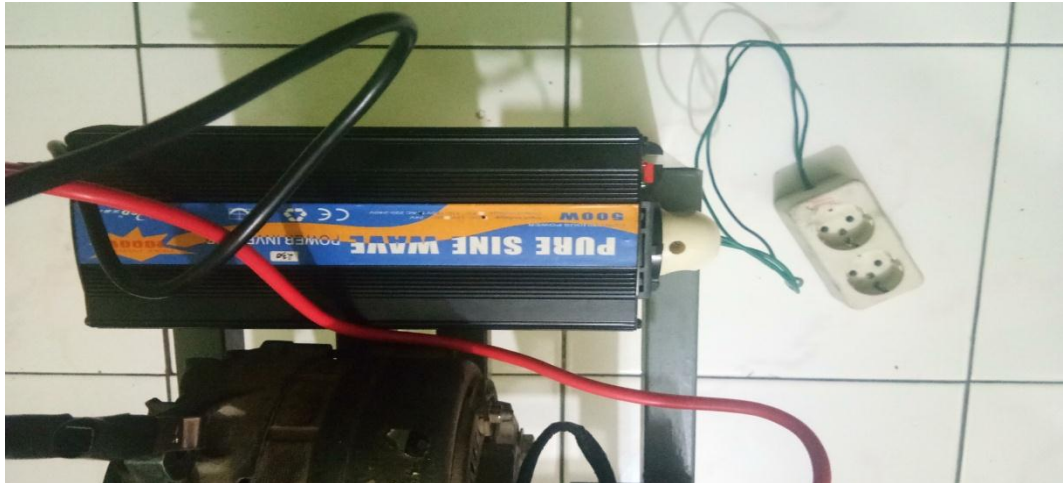
Gambar 3.13 Rangkaian Inverter Dengan Cok Sambung
