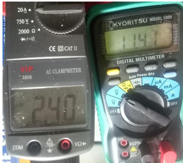
Gambar 3.15 Hasil Pengukuran Output Alternator
