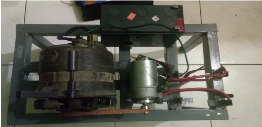
Gambar 3.11 Alat Untuk Pengujian Alternator
