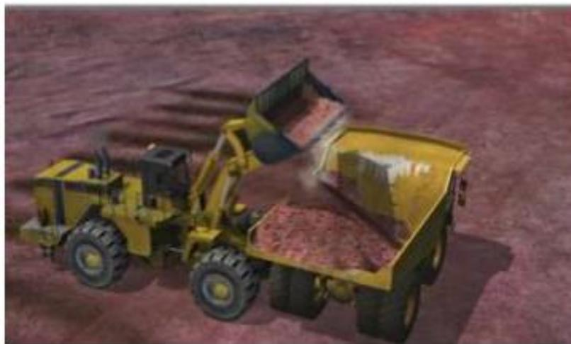
Gambar 2.4 *Wheel Loader* Pada Posisi *L Loading*
