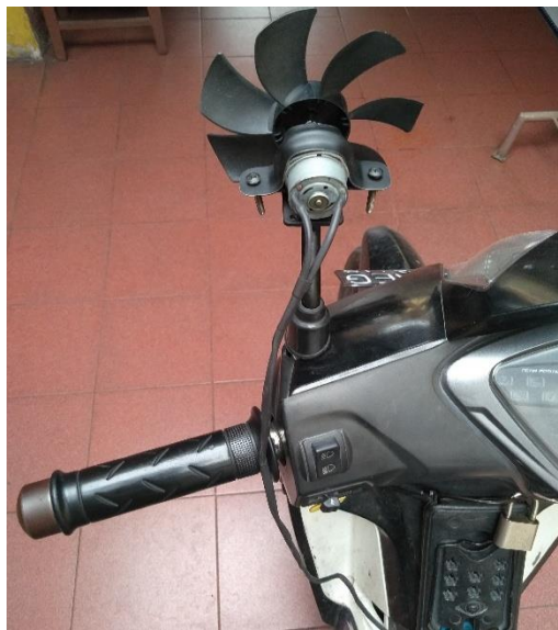
Gambar 3.4 Besi kaca spion sebagaiudukan turbin dan generator.
