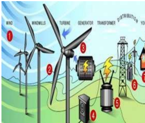
Gambar 2.11 Prinsip Kerja PLTB(Angin)
