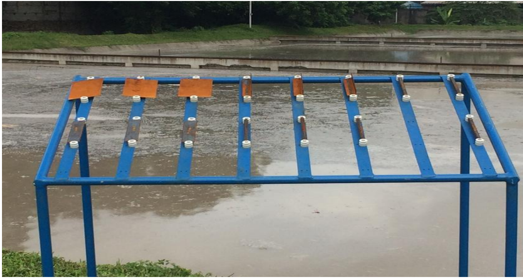
Gambar 2.3. Spesimen yang diekspos di atas rak pengujian
