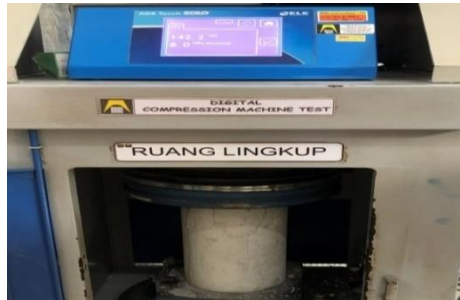
Gambar 4.1 Keretakan silinder setelah pengujian kuat tekan
