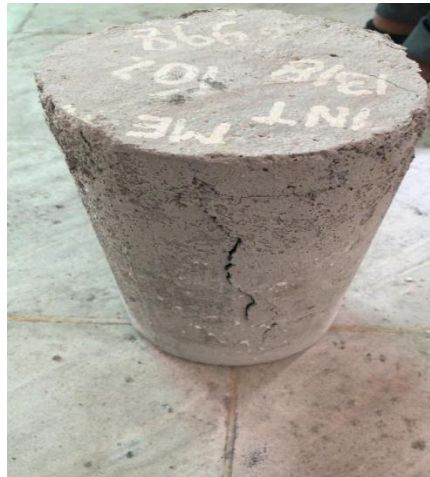
Gambar 4.3 Gambar keretakan silinder setelah pengujian modulus elastisitas
