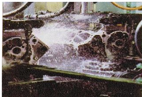
Gambar 2.8 Dibanjiri ke benda kerja
