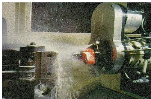
Gambar 2.10 Dengan cara dikabutkan ke benda kerja.
