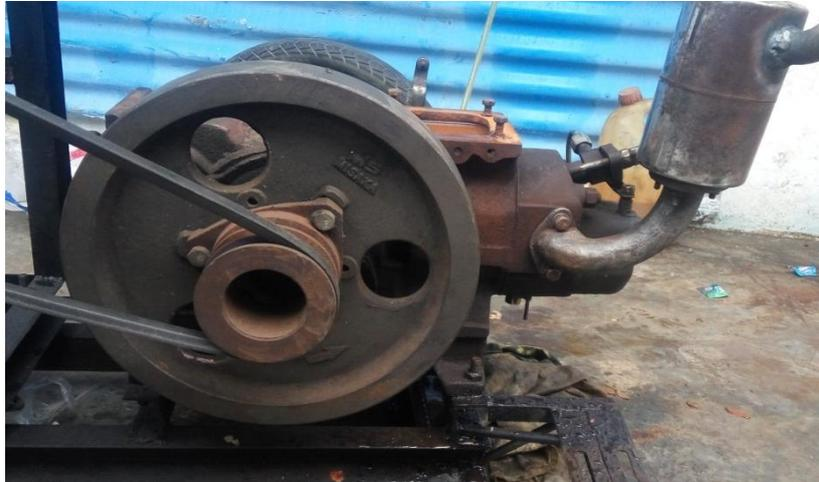
Gambar 3.5 Mesin diesel silinder tunggal
