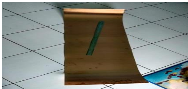
Gambar 3.11 Plat tembaga yang belum dibentuk lingkaran
