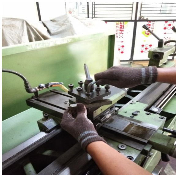
Gambar 3.8 Pemasangan Pahat Mesin Bubut
