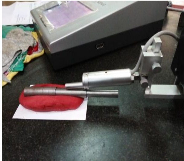
Gambar 3.12 Posisi Alat Uji Terhadap Benda Kerja
