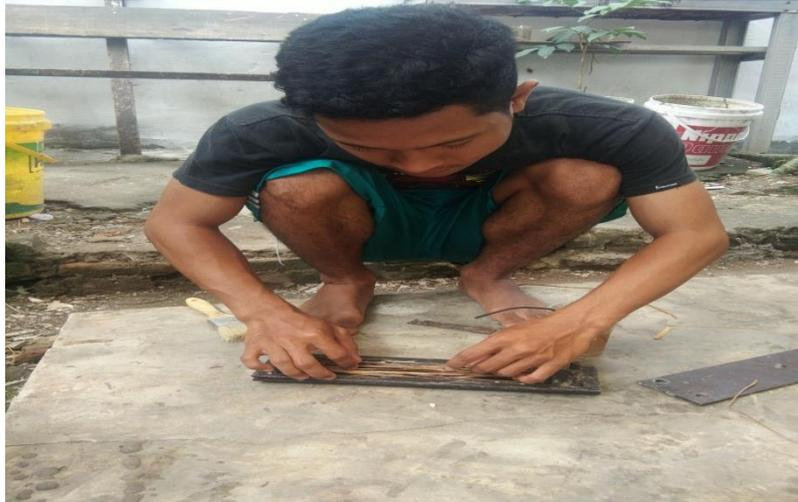
**Gambar 3.17 Penyusunan Serat**
