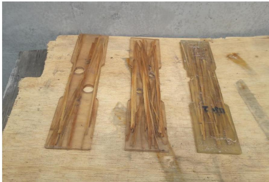
**Gambar 3.20 Proses Penjemuran Spesimen**
