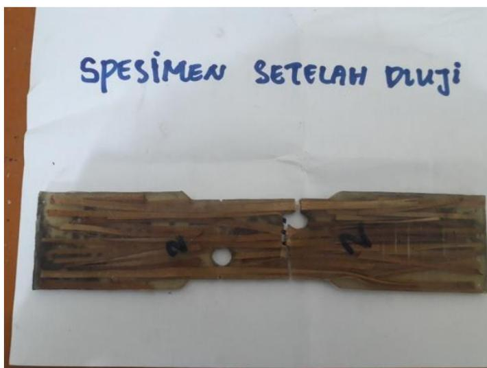
Gambar : 4.4 spesimen komposit sesudah diuji dengan diameter 10 mm
