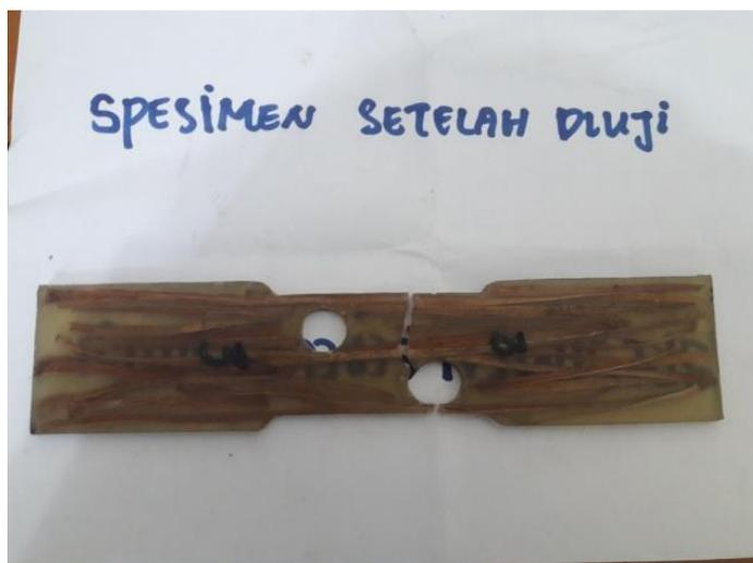
Gambar : 4.6 spesimen komposit sesudah diuji dengan diameter 16 mm
