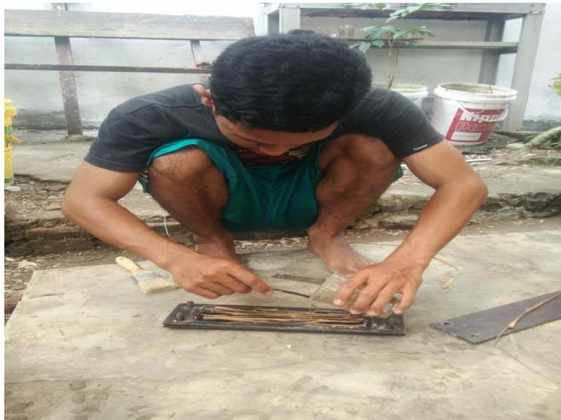
**Gambar 3.16 Penuangan Resin**
