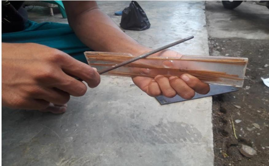
**Gambar 3.21 Pengikiran Spesimen**
