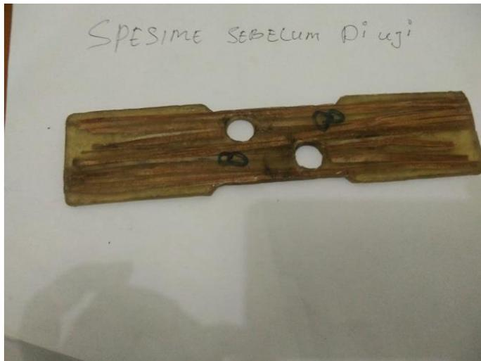
Gambar : 4.5 spesimen komposit sebelum diuji dengan diameter 16 mm
