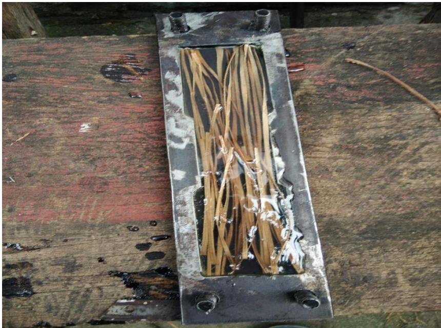
**Gambar 3.18 Proses Pencetakan**
