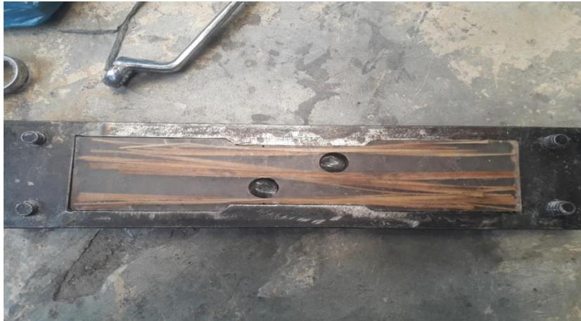
**Gambar 3.19 Proses pengeluaran spesimen dari cetakan**
