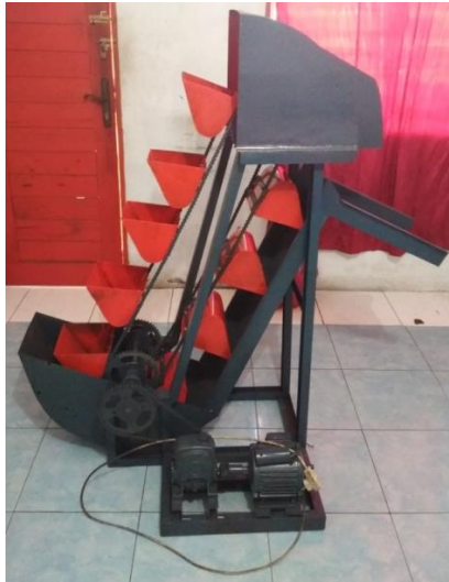
Gambar 4.2 Hasil dari desain prototype alat elevator yang telah selesai dibuat .
