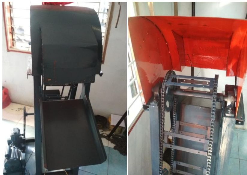
Gambar 3.15 Pemasangan ruang penyalur dan pengeluaran.
