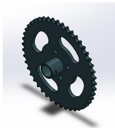
Gambar 3.8 Dimensi sproket dengan jumlah gerigi 46 buah.
