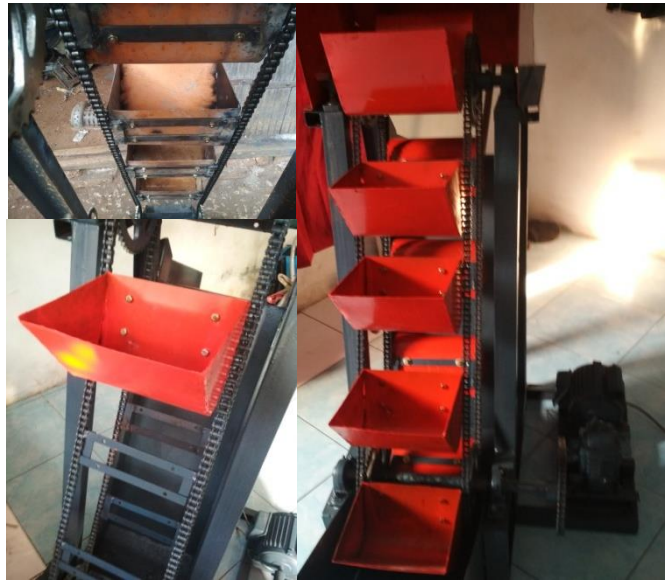
Gambar 3.14 Pemasangan Mangkuk ( Bucket ).
