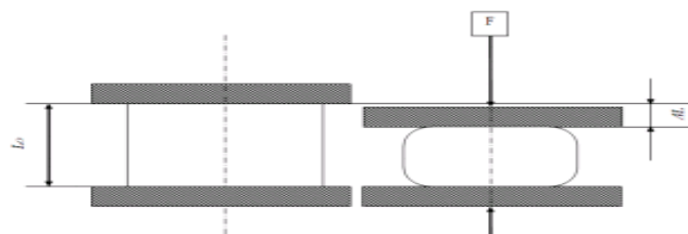
Gambar 2.1 Perubahan benda yang disebabkan oleh tegangan tekan aksial.
