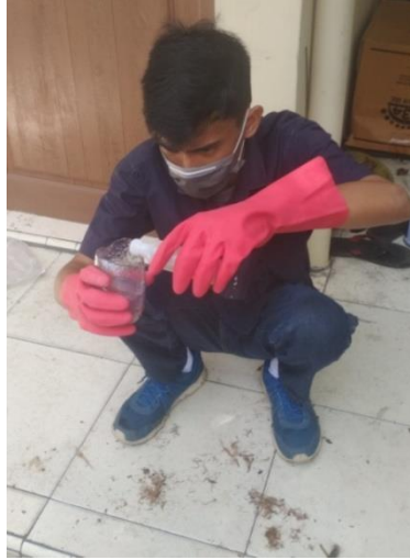
Gambar 3.23 Menuang katalis kedalam wadah yang berisi resin.
