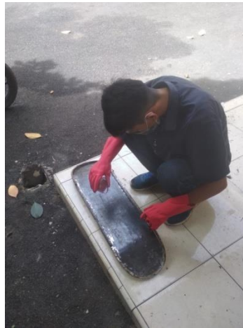
Gambar. 3.24. Penuangan resin dan katalis serat kedalam cetakan spesimen.
