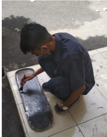
Gambar. 3.20 Mengoleskan mirror glaze pada bagian cetakan spesimen.
