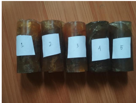
Gambar 4.2. Spesimen uji tekan
