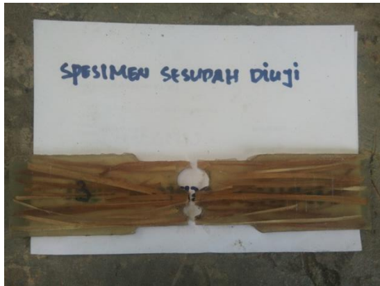
Gambar : 4.6 spesimen komposit sesudah diuji dengan diameter besar 16 mm, kecil 8 mm.
