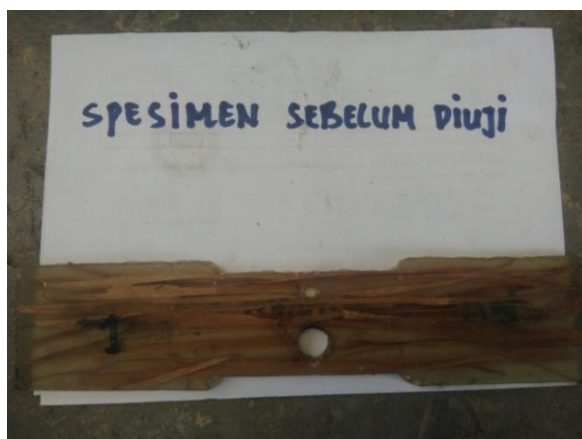
Gambar : 4.1 spesimen komposit sebelum diuji dengan diameter besar 12 mm, kecil 6 mm.
