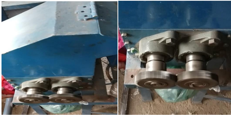
Gambar 4.4 pengujian dan posisi bearing pada mesin
