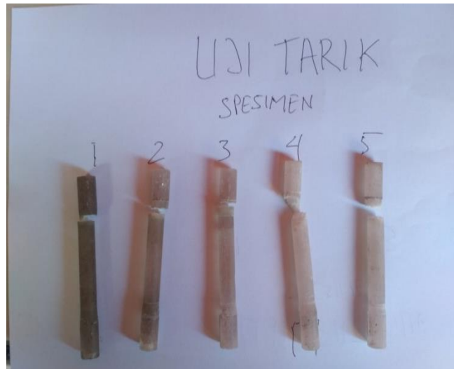
Gambar 4.1 Hasil pengujian tarik specimen komposit
