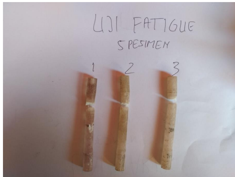
Gambar 4.5 Patahan specimen pengujian Fatigue
