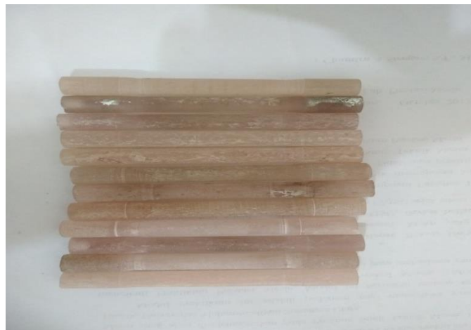
Gambar 3.30 Bentuk specimen yang sudah di bubut
