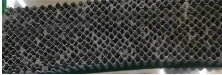
Gambar 3.24 Spesimen Sarang Lebah Ukuran 2 mm
