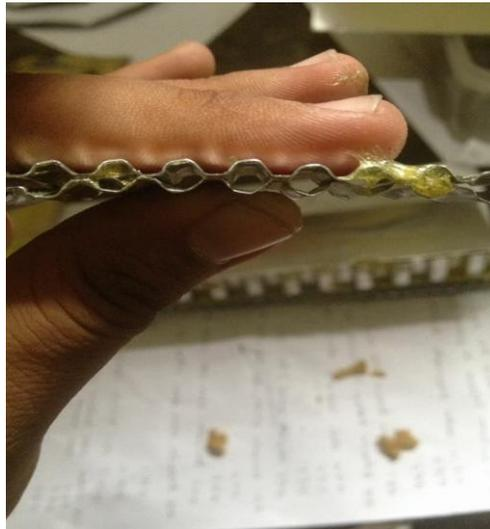
Gambar 3.22 Pengeleman *Core* Ukuran 2 mm
