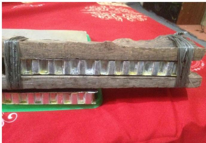
Gambar 3.30 Pengepresan Spesimen Ukuran 6 mm
