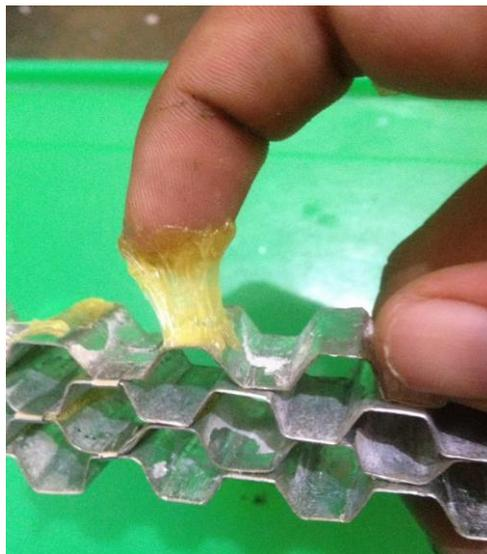
Gambar 3.23 Pengeleman *Core* Ukuran 6 mm
