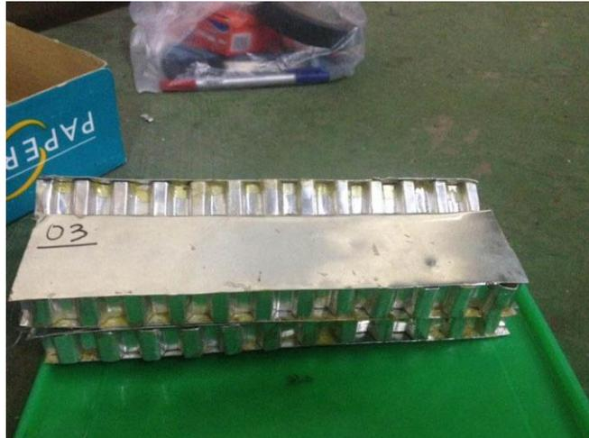
Gambar 4.2 Hasil Pembuatan Spesimen Ukuran 6 mm
