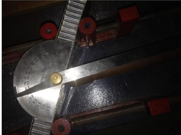
Gambar 3.37 Menyetel Kemiringan Spesimen
