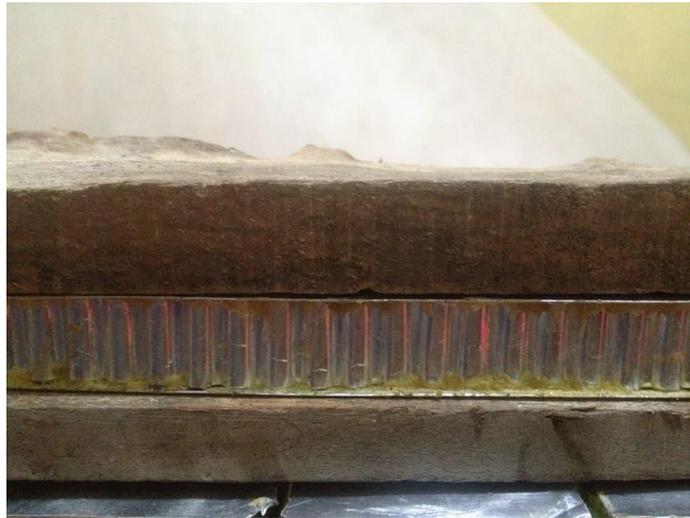
Gambar 3.29 Pengepresan Spesimen Ukuran 2 mm
