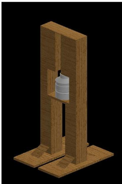
Gambar 2.7. Alat ukur konsumsi bahan bakar solar
