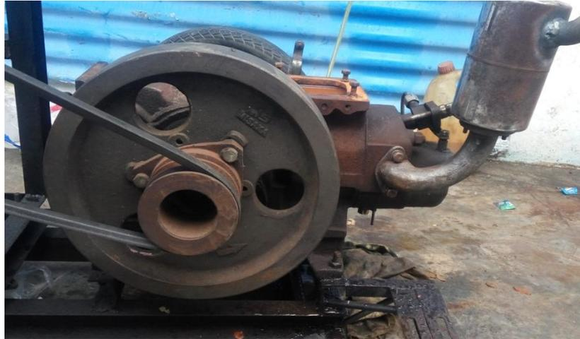
Gambar 3.3. Mesin Diesel Silinder Tunggal
