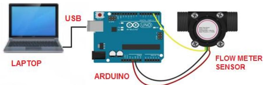
Gambar 3.13. Skema rangkaian Flow meter sensor
