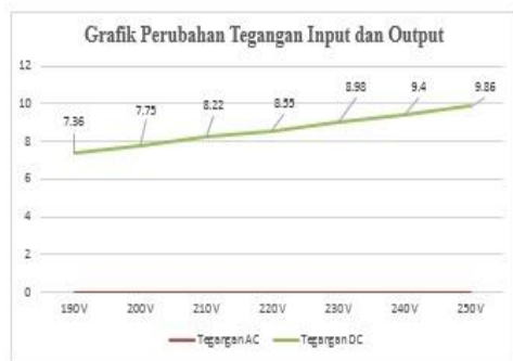
Gambar 4.2 Grafik Perubahan Tegangan Dari Voltage Regulator dan Trafo CT
