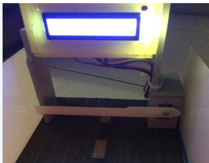
Gambar 4.6 Rangkaian Servo Penutup Portal
