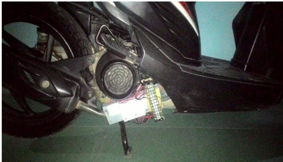
**Gambar 3.2** Alat Uji saat dipasang pada *Exhaust* Sepeda Motor
