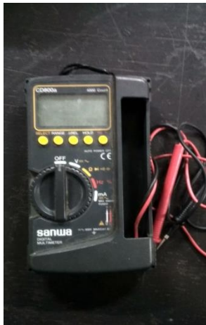
Voltmeter untuk mengukur input baterai dan output inverter
