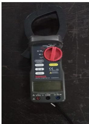
Amperemeter untuk mengukur besarnya arus dari inverter
