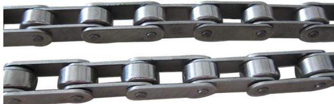
Gambar 2.6. Rantai konveyor dengan jarak bagi ganda
