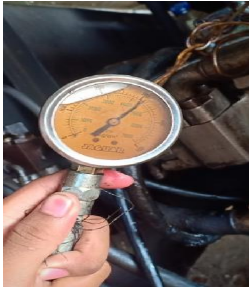
Gambar 3.6. Pompa Diukur Dengan Pressure
