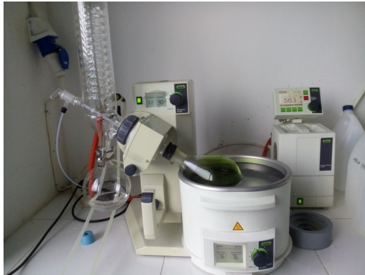
Proses penyulingan ekstrak fungisida nabati
