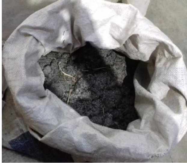
Gambar L5: Jerami padi yang sudah melalui proses pembakaran.
