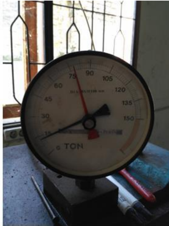
Gambar L13: Uji kuat tekan beton campuran limbah keramik 30% dan abu jerami padi 10% 28 hari: 78 T.
