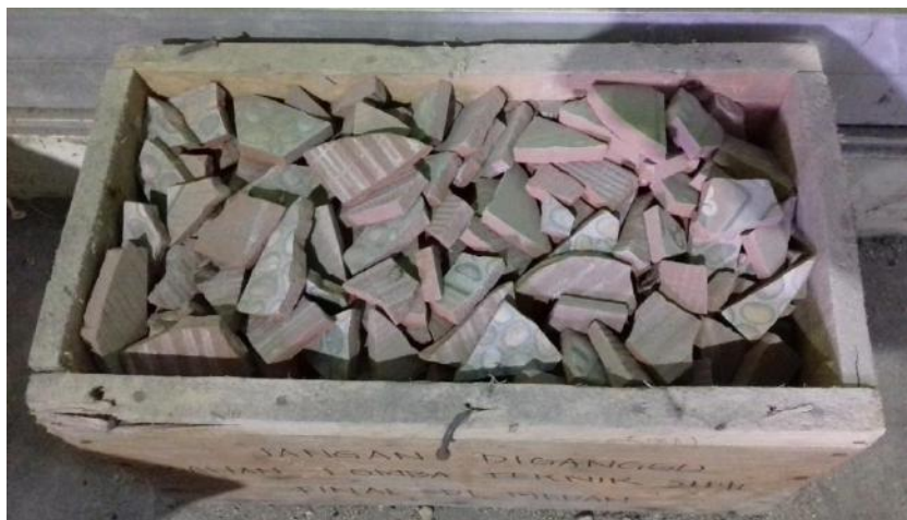
Gambar L4: Keramik yang sudah melewati proses penghancuran.
