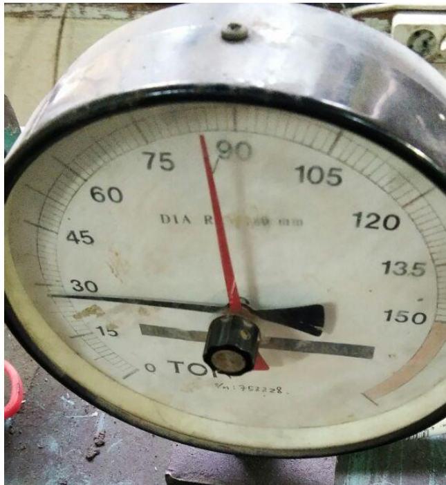
Gambar L12: Uji kuat tekan beton campuran limbah keramik 15% dan abu jerami padi 10% 28 hari: 81 T.
