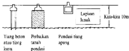
Gambar 2.7: Contoh pondasi bila lapisan pendukung pondasi berada sekitar 10 meter dibawah permukaan tanah (Sosrodarsono dan Nakazawa, 2000).
