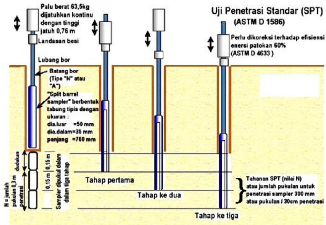
Gambar 2.4: Skema urutan pengujian penetrasi standar (SPT) (SNI 4153, 2008).
