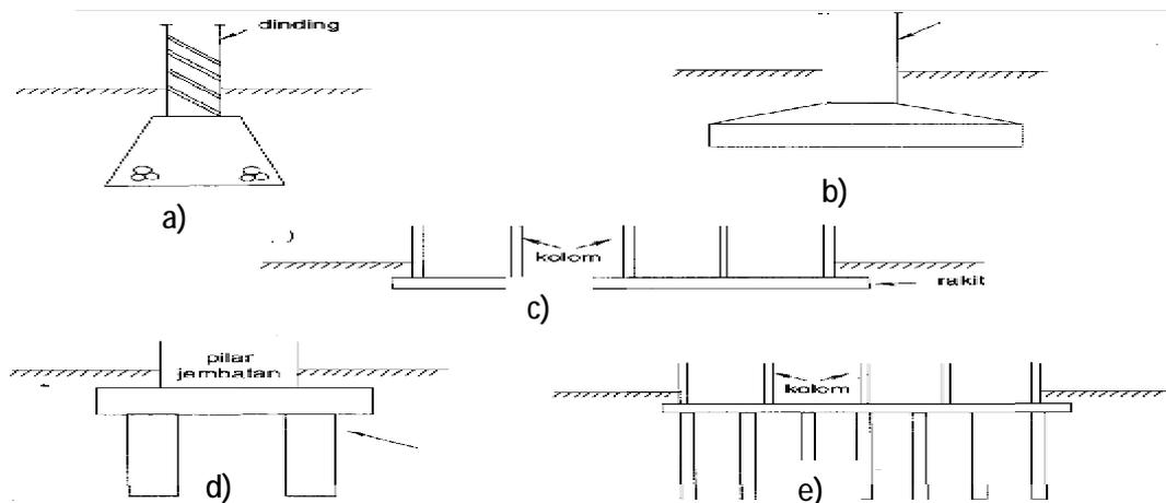
Gambar 2.5: Macam-macam *type* pondasi: a) Pondasi memanjang, b) Pondasi telapak, c) Pondasi rakit, d) Pondasi sumuran, e) Pondasi tiang (Hardihardaja, 1997).
