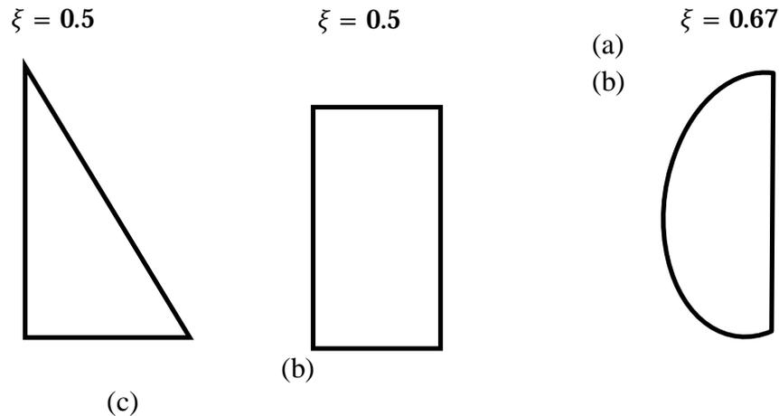
Gambar 2.12: Variasi jenis bentuk unit tahanan friksi (kulit) alami terdistribusi sepanjang tiang tertanam ke dalam tanah (Das, 2007).
