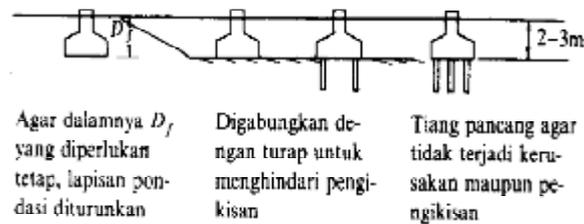
Gambar 2.6: Contoh pondasi bila lapisan pendukung pondasi cukup dangkal (Sosrodarsono dan Nakazawa, 2000).
