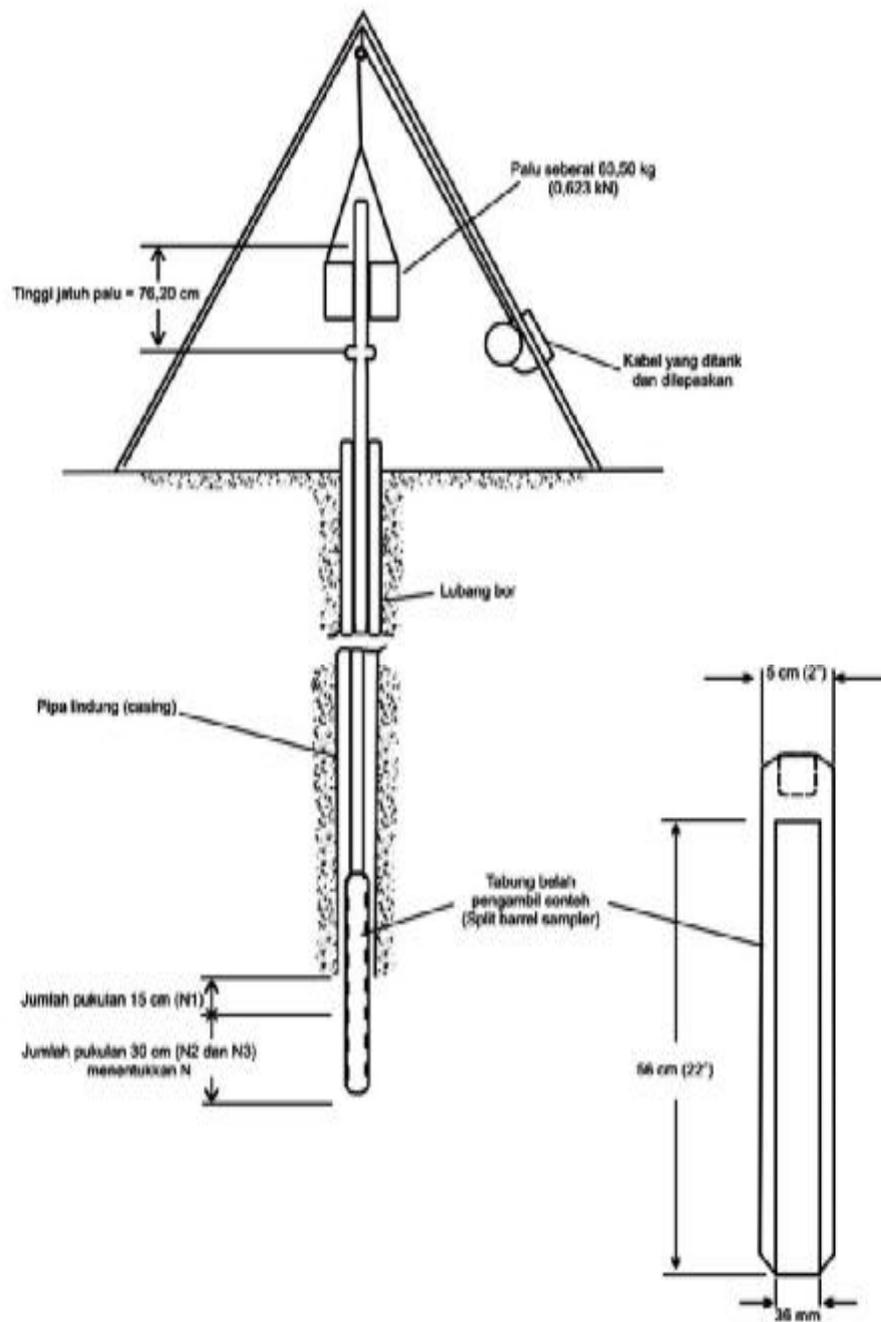
Gambar 2.3: Pengujian penetrasi standar (SPT) (SNI 4153, 2008).
