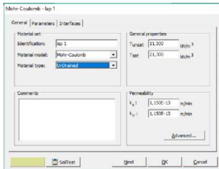
Gambar 3.6: Input parameter tanah dan pemodelan Mohr-coulomb.
