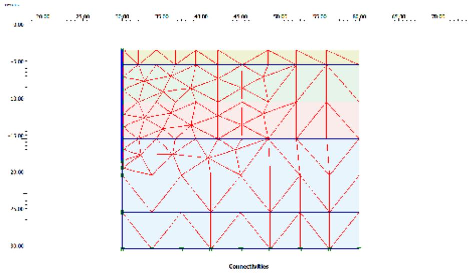
Gambar 3.7: Penyusunan jaring Mesh.
