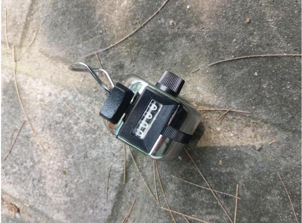
Gambar L.27: Hand counter (alat yang digunakan diwaktu survey lalu lintas)
