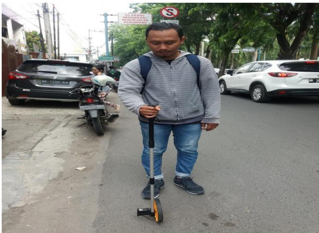
Gambar L.24: Survei geometrik jalan (panjang jalan)
