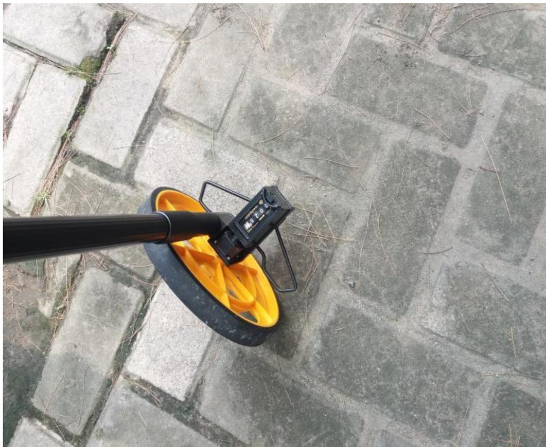
Gambar L.27: Survei geometrik jalan (panjang trotoar dan gambar alat yang dipakai saat pengukuran)
