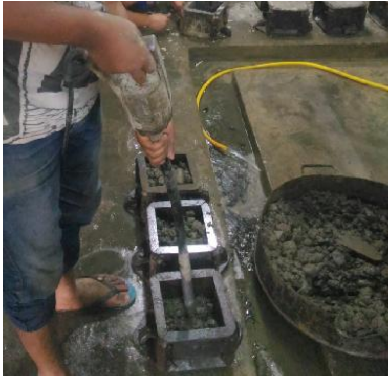
Gambar L8: Pores vibrator pada beton.
