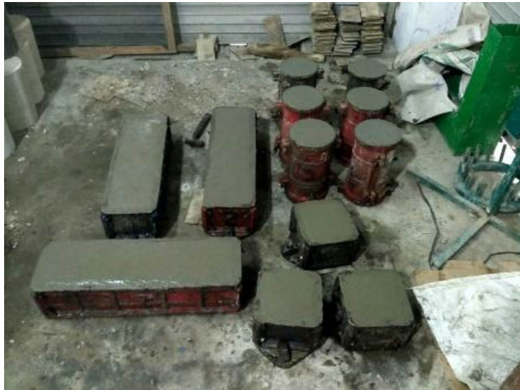
Gambar L9: Benda uji yang telah selesai di cetak.
