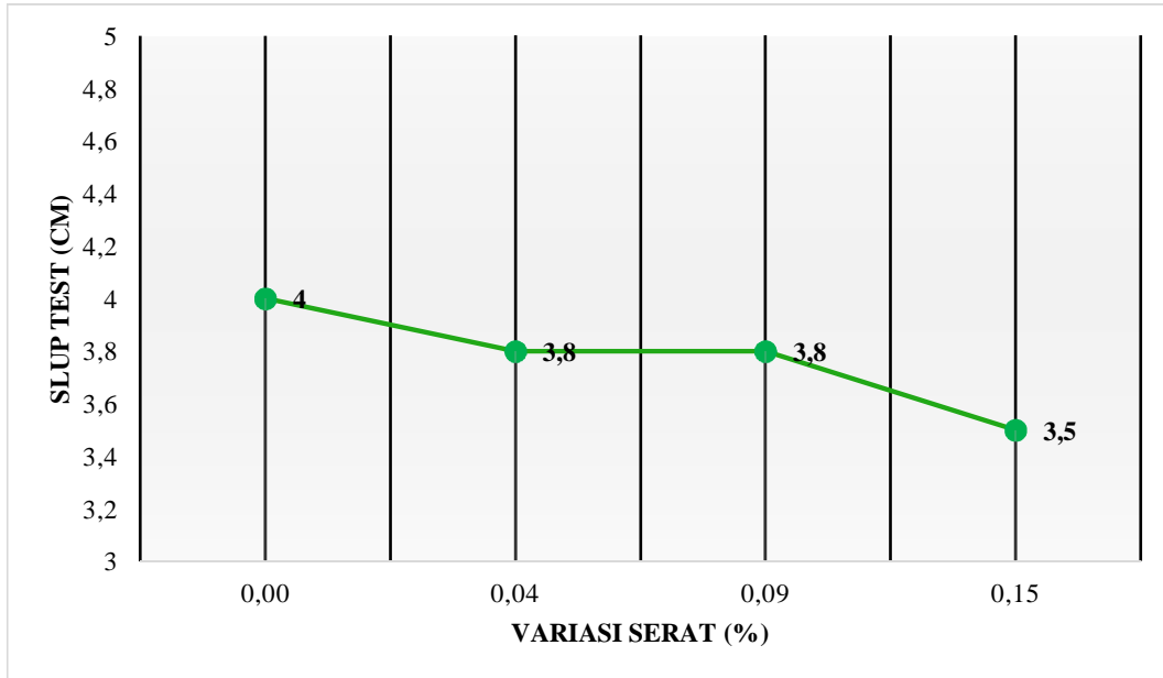
Gambar 4.2: Kurva slump test dengan FAS 0,38.
