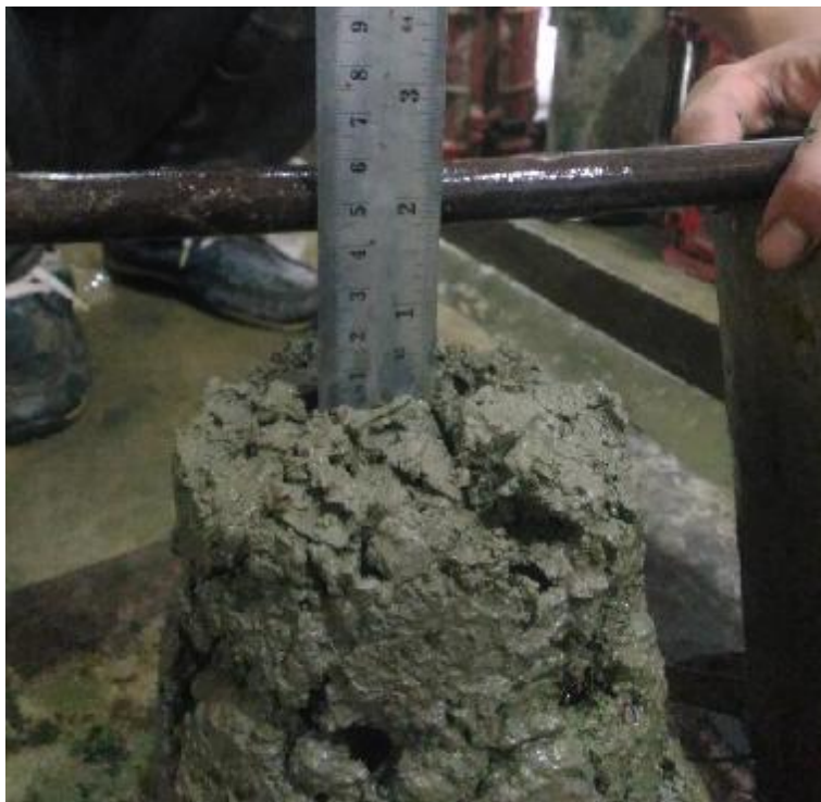
Gambar L7: Pengujian slump test pada semua benda uji.
