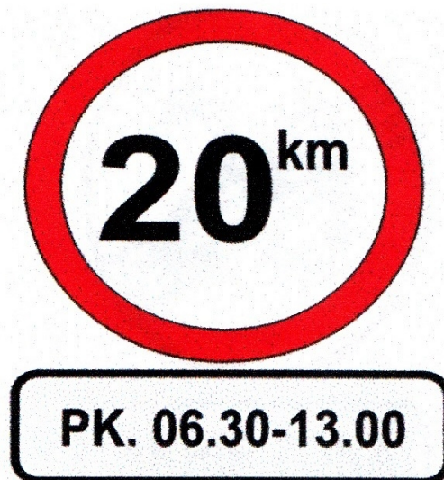
Gambar 2.12 : Rambu Batas Kecepatan Maksimum dengan papan tambahan informasi periode batasan kecepatan (Direktorat Jendral Perhubungan Darat, 2006).
