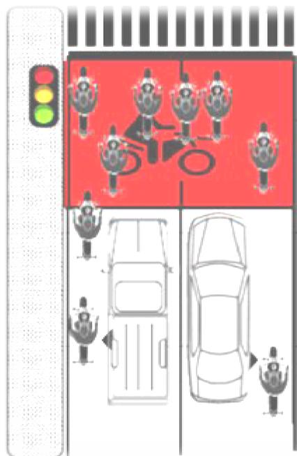
Gambar 2.16: Tampak atas sepeda motor memasuki RHK tanpa lajur pendekat (Balai Teknik Lalu Lintas dan Lingkungan Jalan, 2012).
