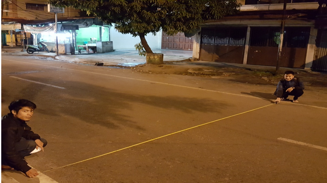
Gambar L.1: Mengukur lebar jalan.
