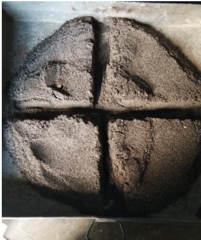
Gambar L4: Pengambilan bahan metode quartering agregat halus.
