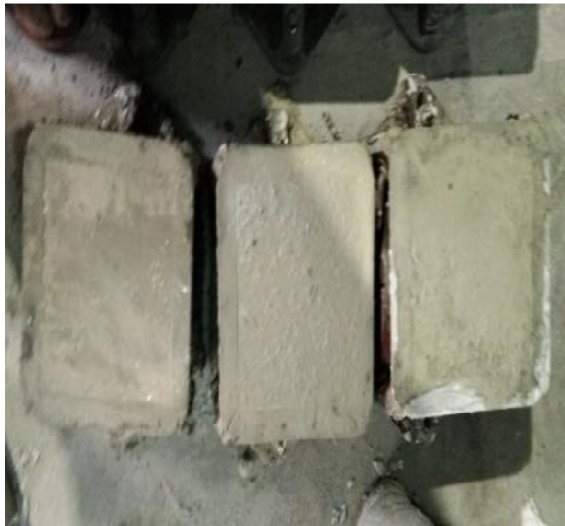
Gambar L12: Beton di dalam cetakan kubus 15 x 15 x 15 cm.
