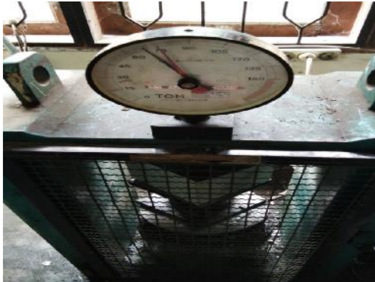
Gambar L15: Uji kuat tekan beton dengan Viscocrete 1003 0,5 % 28 hari = 75 T.
