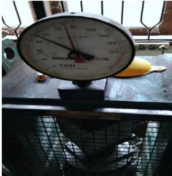
Gambar L17: Uji kuat tekan beton dengan Viscocrete 1003 0,5 % dan abu tempurung kelapa 7,5 % 28 hari = 81 T.
