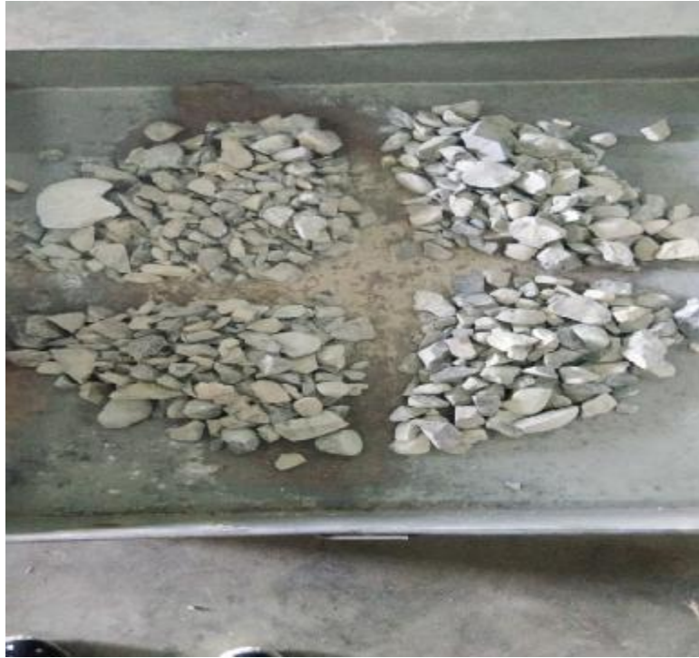
Gambar L3: Pengambilan bahan metode quartering agregat kasar.
