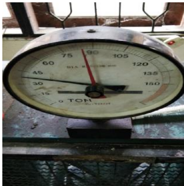
Gambar L18: Uji kuat tekan beton dengan Viscocrete 1003 1,5 % dan abu tempurung kelapa 7,5 % 28 hari = 85,5 T.
