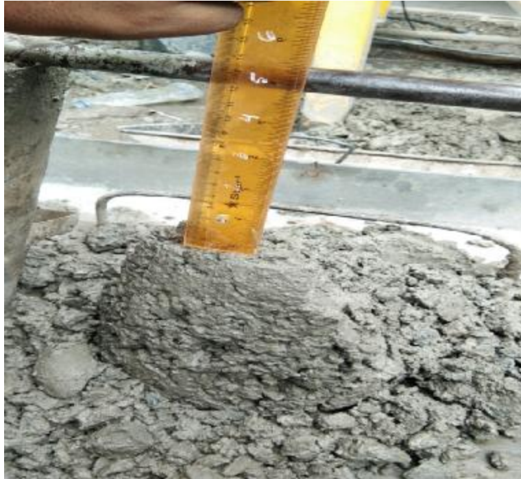
Gambar L11: Hasil pengujian slump test beton ditambah Viscocrete 1003 .
