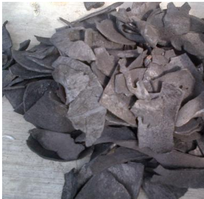
Gambar L8: Tempurung kelapa yang telah dibakar menjadi arang.
