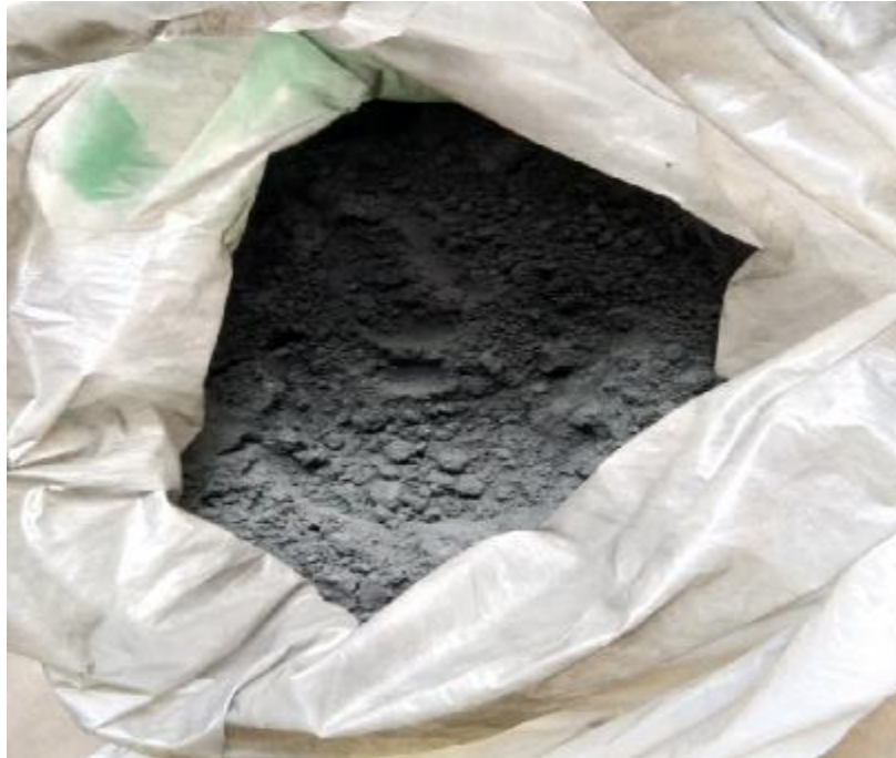
Gambar L9: Limbah arang tempurung kelapa yang tertahan disaringan No.200.
