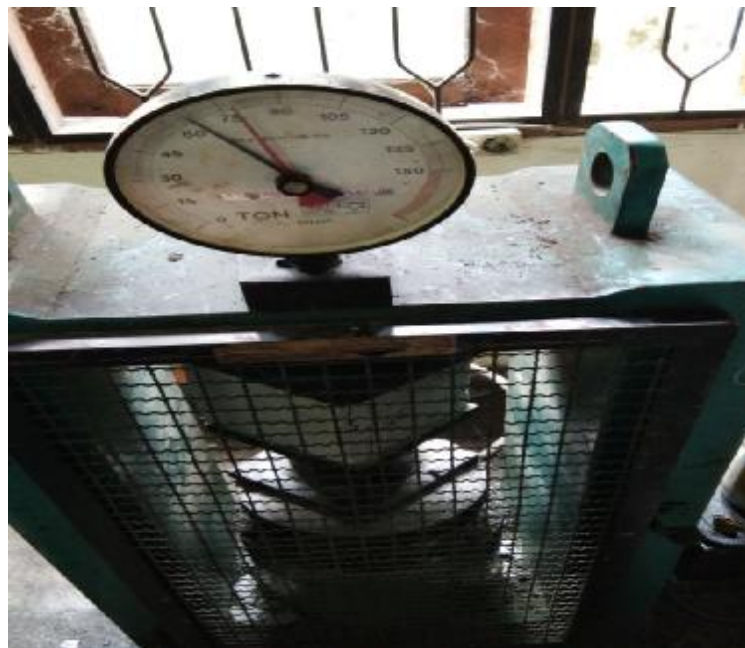
Gambar L16: Uji kuat tekan beton dengan Viscocrete 1003 1,5 % 28 hari = 78 T.
