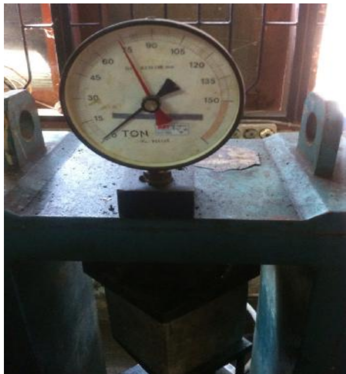
Gambar L14: Uji kuat tekan beton normal 28 hari = 72 T.
