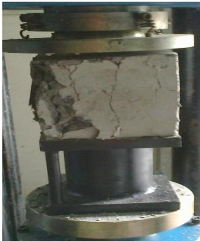
Gambar L11: Hasil proses uji tekan pada beton.
