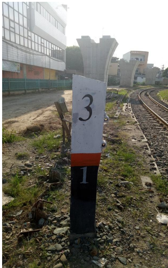
Gambar L.4: Survey lengkung rel pada patok no.3.
