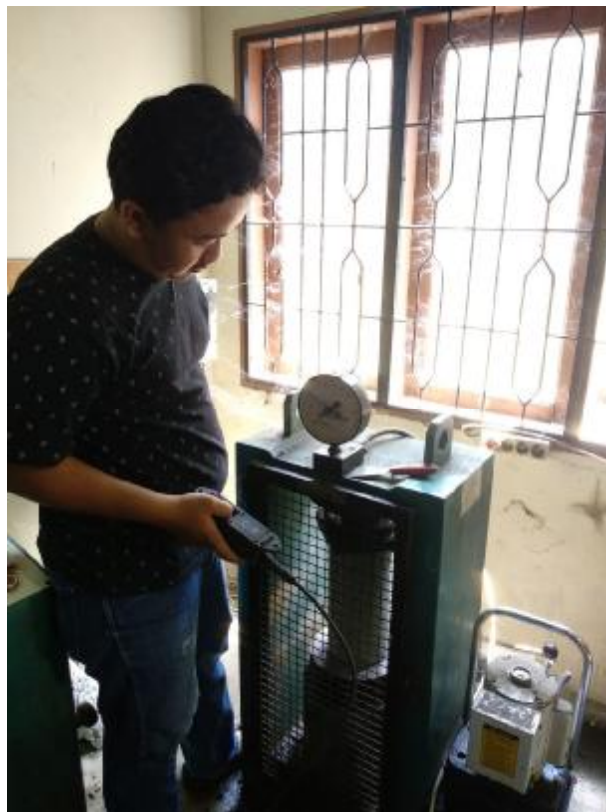
Gambar L.8. Pengujian kuat tekan
