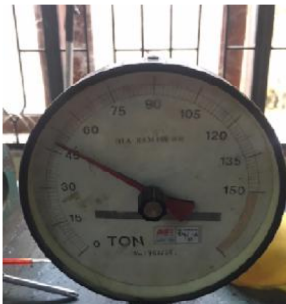
Gambar L.9. Nilai beban tekan untuk salah satu benda uji berumur 28 hari
