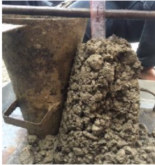
Gambar L.5. Pengujian nilai slump
