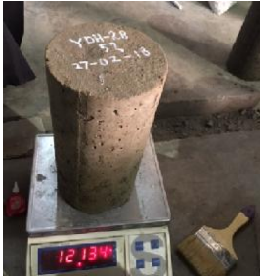
Gambar L.7. Benda uji dengan bahan tambah
