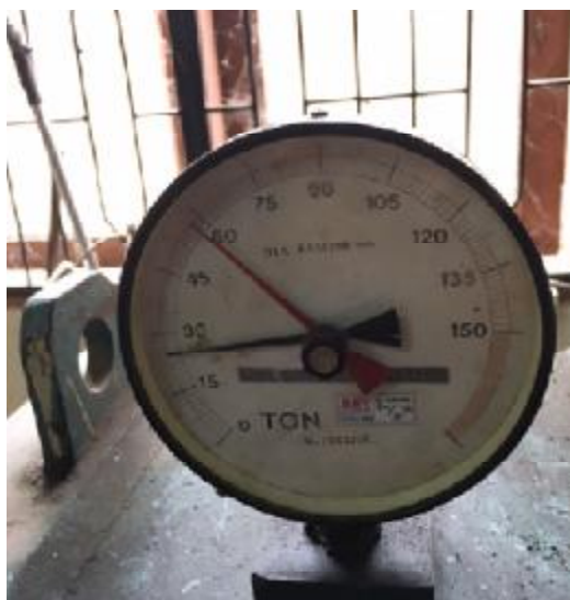
Gambar L.10. Nilai beban tekan untuk salah satu benda uji berumur 7 hari
