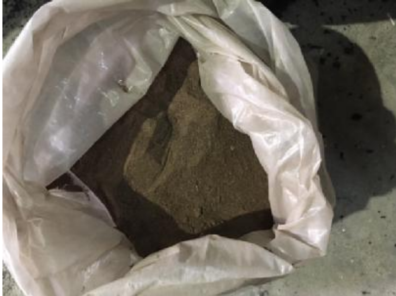
Gambar L.4. biji durian setelah dilakukan penyaringan lolos saringan no. 50
