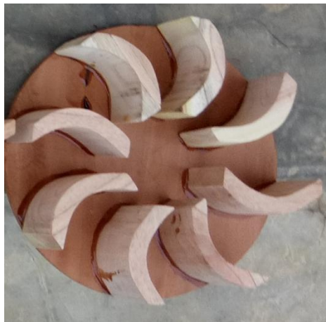
Gambar 3.4 Impeller jumlah 8 sudu 109^\circ
