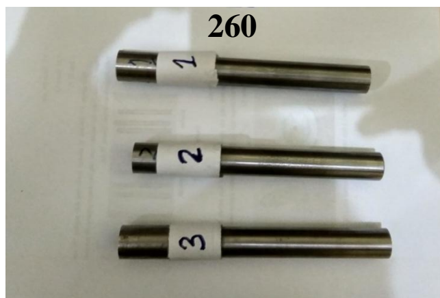
Gambar 4.11 Spesimen 0,1 mm, 0,2 mm, 0,3 mm, kedalaman penggerindaan pada kecepatan putaran spindle 260 rpm
