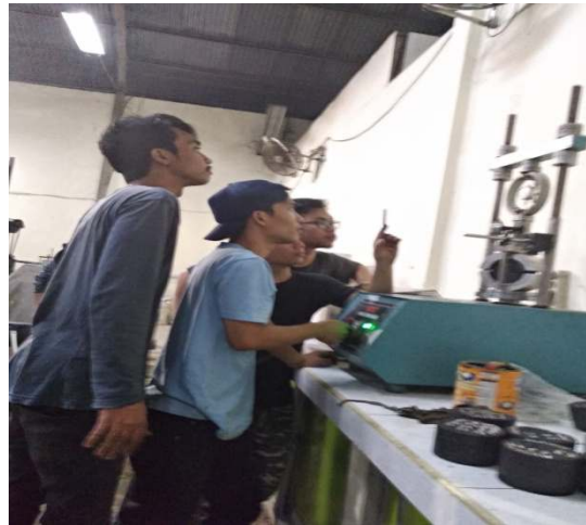
Uji kuat tekan marshall pada benda uji
